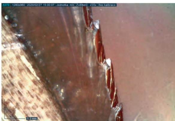
Obr. 5: Zobrazení praskliny po působení vodní páry na testovaném vzorku. (Tesařová, 2020)
