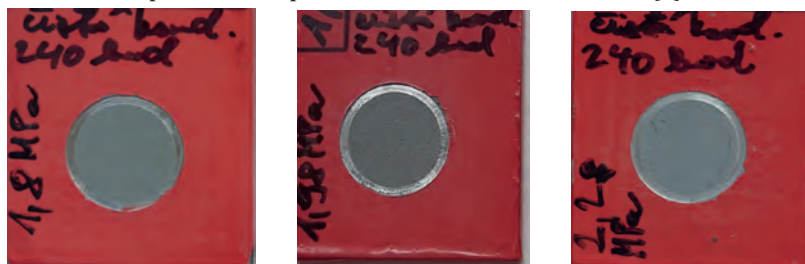
Obr. 6: Charakter lomu a odtrhové pevnosti ve zkoušce kolmým odtrhem kombinace ZSN + Penetral (pouze levý a střední snímek) + S2321 2x: vlevo Penetral 1 (pH 10), střední Penetral 2 (pH 9,5) a vpravo bez penetrace, působení Penetralů po dobu 3 hod při RV < 40%, bez následného oplachu a ihned poté nanesena první vrstva 22321, stav po 240 hod expozice ve zkoušce čistá kondenzace [9]
