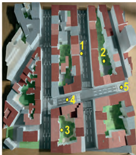
Obr. 1: 3D tištění model města – pro in-situ měření a simulaci ochrany ovzduší v Praze, ulice Legerova
