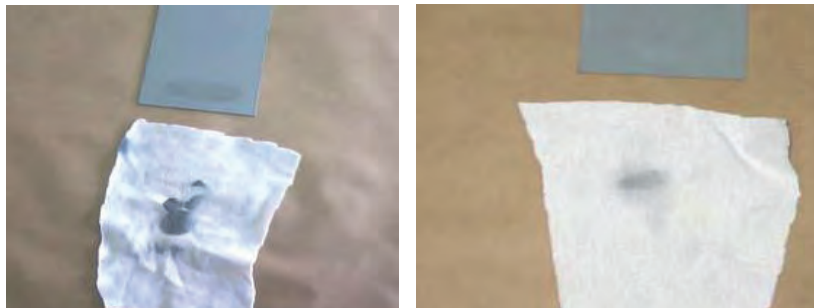
Obr. 4: Rozdíl mezi nevytvrzeným ZSN (obráz. vlevo, probroušení k podkladu) a dostatečně vytvrzeným na stupeň 4 (obráz. vpravo, pouze rozleštění povrchu), MEK testu pod organický nátěr po ořetu 50 dvojtahů v MEK testu dle ASTM D4752
