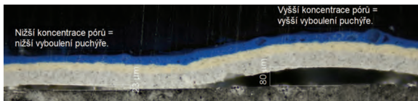
Obr. 15: Nález kombinovaného porušení PÚ, současná delaminace celého 3V-NS s tvorbou puchýřů + roztržení nátěrového systému ve žluté mezivrstvě. 100x, TP
