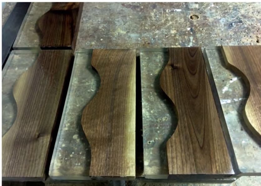
Obr. 1.: Pohled na část vyrobených vzorků kompozitu epoxidové pryskyřice a masivního dřeva
