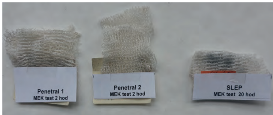
Obr. 5: Stav vytvrzení ZSN účinkem přípravků Penetral 1 (pH 10) a Penetral 2 (pH 9,5) po 2 hod působení přípravků, oproti stavu vytvrzení bez penetračního přípravku (SLEP) po 20 hod, hodnocení dle intenzity zašpinění otěrové gázy v MEK testu po 50 dvojtazích otěru
