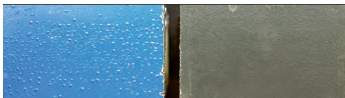
Obr. 4: Srovnávací ověření odolnosti NS vůči vlhkosti v urychlené vlhkostní zkoušce, 48 h
