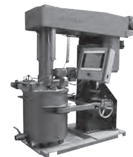
Obr. 2: Příklad dissolveru Netzsch MasterMix, zde s pojízdnou nádobou.
