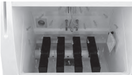
Obr. 3: Proudění vzduchu kolem testovaných panelů do sběrného válce v komoře Ascott
