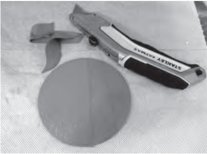
Obr. 3: Mechanické odstranění povlaku Anti-Rust
