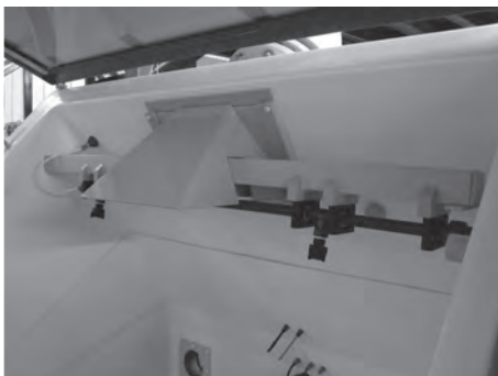
Obr. 4: Oscilující trysky dle VCS norem v horní části komory
