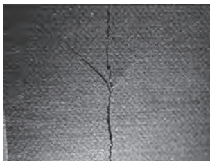
Obr. 2: Detail rozvětvení trhliny v pryži
