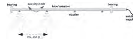
Obr. 1: Oscilující trubice s tryskami dle VCS 1027-149
