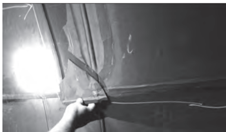
Obr. 5: Odběr vzorku vrstvy pogumování s lepeným spojem k mikroskopickému zkoumání
