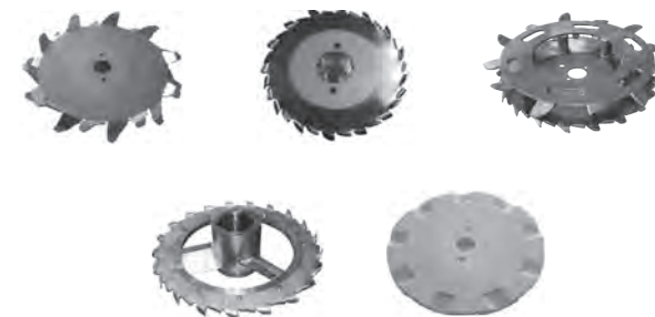
Obr. 3: Různé dispergační disky pro dissolver, nahoře zleva: hrubý zubový disk, jemný zubový disk, dvojitý čerpací disk, dole: speciální čerpací disk pro vyšší viskozity, PU disk pro abrazivní materiály.
