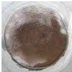
Obr. 15 – pH~12, bez PAL, hydrofobní povrch Obr. 16 – pH~12 + PAL, smáčivý, hydrofilní povrch
