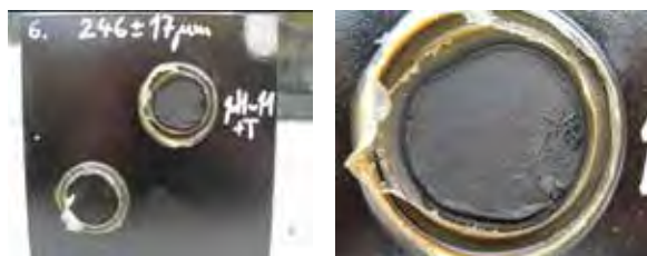
Obr. 9, 10 – Střídání teplot 17 až 50 °C, pH~11 + PAL, degradace ochranné vrstvy a koroze oceli
