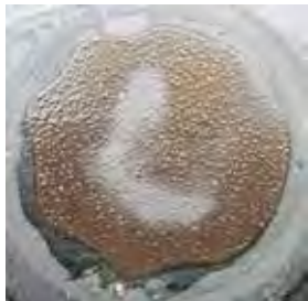
Obr. 15 – pH~12, bez PAL, hydrofobní povrch Obr. 16 – pH~12 + PAL, smáčivý, hydrofilní povrch
