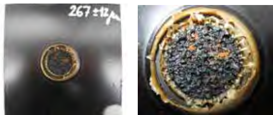
Obr. 9, 10 – Střídání teplot 17 až 50 °C, pH~11 + PAL, degradace ochranné vrstvy a koroze oceli
