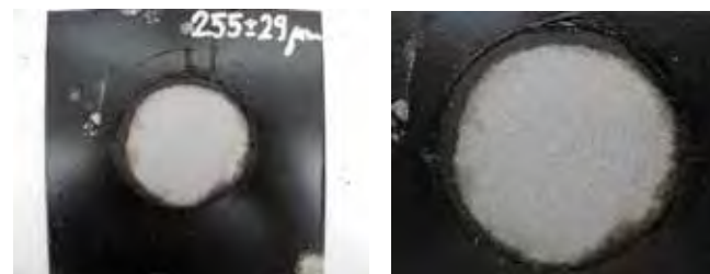
Obr. 5, 6 – Po 80 cyklech -5 °C až +20 °C, čistá voda, pH~7, podkladová ocel bez korozního napadení
