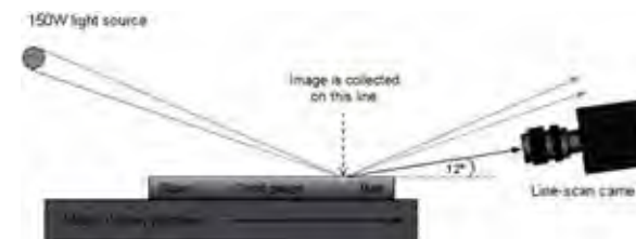
Obr. 3 – Geometrie uspořádání během snímání [3]
