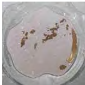
Obr. 15 – pH~12, bez PAL, hydrofobní povrch Obr. 16 – pH~12 + PAL, smáčivý, hydrofilní povrch
