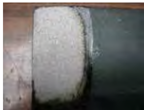
Obr. 4 – DFT 224±26 µm, bez koroze tryskané oceli
