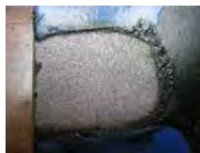
Obr. 3 – DFT 206±16 µm, bez koroze tryskané oceli
