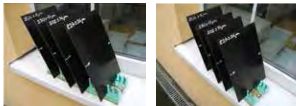
Obr. 3 – DFT 206±16 µm, bez koroze tryskané oceli
