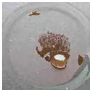
Obr. 15 – pH~12, bez PAL, hydrofobní povrch Obr. 16 – pH~12 + PAL, smáčivý, hydrofilní povrch
