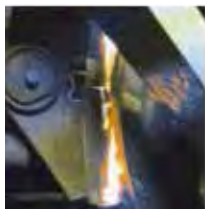
Obr. 1 – Rozžeravené brzdové klátiky
