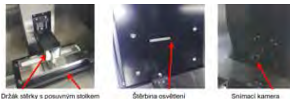
Obr. 2 – Vnitřní komponenty přístroje TIDAS
