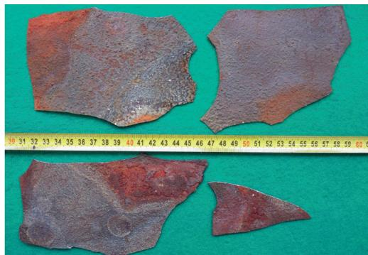
Obr. 2: Detailní pohled na vnitřní stranu vrstvy tmelu Belzona 1511, původně přiléhající k tryskané oceli vnitřního pláště stripovací kolony. Lze nalézt vysoké množství velkých pórů zabudovaných ve vrstvě tmelu na rozhraní tmel / tryskaná ocel. Póry jsou dost velké na to, aby je ani tlustá červenohnědá vrstva korozních produktů železa nepřekryla.
