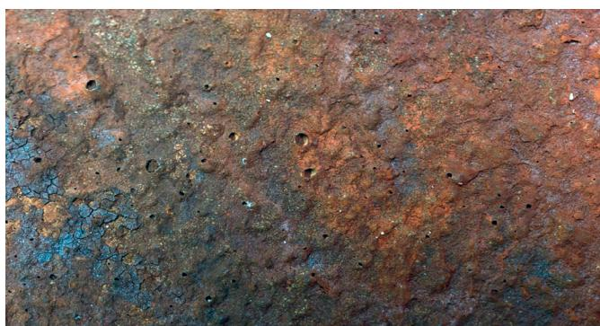
Obr. 3: Fotografie šikmého řezu vrstvami NS. Spodní světlá část NS – vysokosušinový tmel Belzona 1511, zřetelná linie rozhraní, horní část NS s načervenalým odstínem vysokosušinový nátěr Belzona 1593. Co je nepřípustné, je zjištění, že obě vrstvy NS jsou prostoupené vysokým množstvím pórů.
