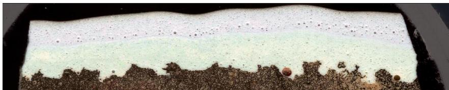
Obr. 4: Mikroskopický pohled na šikmý řez NS. Zvýraznění obrovského množství pórů v celém NS, s jasnou liníí rozhraní mezi spodní vrstvou tmelu Belzona 1511 a vrchním nátěrem Belzona 1593. Při podrobnějším zkoumání lze nalézt množství míst s propojením dvou i více pórů. 25x SP.
