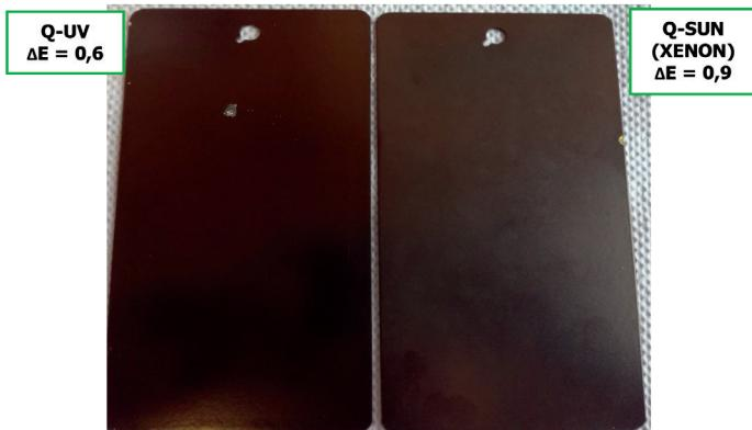
Obr. 8: Porovnání hodnot Q-UV a Q-SUN (XENON) na vzorcích světlo-stálého NS LV AKZ 421
