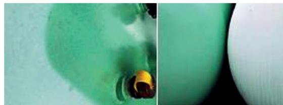
Vzorky byly dle přání exponovány v Q-UV testu po dobu 500 hodin s cílem zjistit příčinu. Již po 264 hodinách NS vykazoval neuspokojivé výsledky se ztrátou lesku větší než 80% s  $\Delta E > 5$ . Po 500 h, kdy byl test ukončen, NS nevykazoval již ani náznak původního RAL odstínu s kompletní ztrátou lesku a  $\Delta E > 10$ , viz obr. 10.
