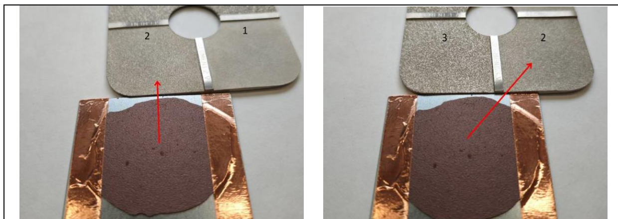
Obr.3 - 4 vizuální porovnání drsnosti profilu primeru vůči ISO komparátoru na Segment 2.
