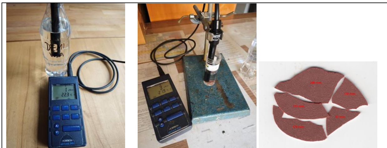
Obr. 17 - 18 Stanovení vodivosti výluhu z odebraných vzorků NS. Obr. 19 stanovení povrchu vzorků použitých k provedení výluhu.
