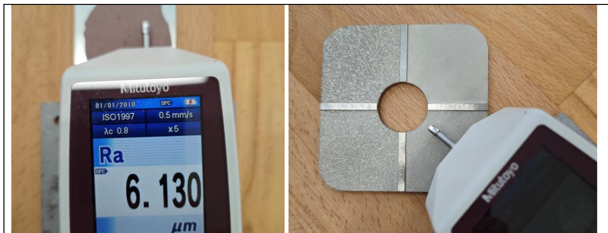
Obr.1 - 2 zaměření profilu povrchu delaminovaného primeru a ISO komparátoru.
